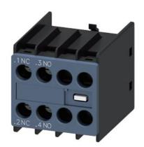
auxiliary switch, on the front, 1 NO + 1 NC, .1/.2, .3/.4, --/--, --/--, current path: 1 NC, 1 NO, --, --, screw terminal, for contactors 3RT2 and contactor relays 3RH2
