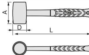
打撃物に傷をつけにくい、ヘッドがゴム製のハンマーです。グラスファイバー柄を採用し、軽量で耐久性に優れています。
