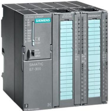
SIMATIC S7-300, CPU 314C-2PN/DP 紧凑型 CPU，带 192 KB 工作存储器，24 DE/16 DA, 4AE, 2AA, 1 Pt100, 4 个快速计数器(60 kHz), 1 个 MPI/DP 12MBit/s 接口, 2 个以太网 PROFINET 接口, 带双端口交换机, 集成电源 24V DC, 前连接器 (2x 40 极) 和需要微型存储卡
